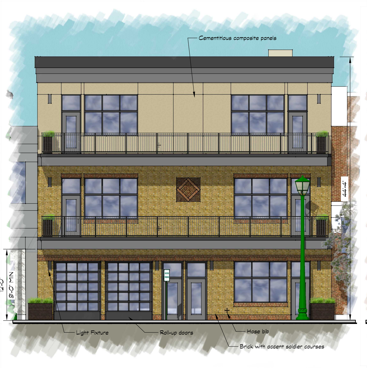
Front Elevation Scale: 1/8" = 1'-0"
